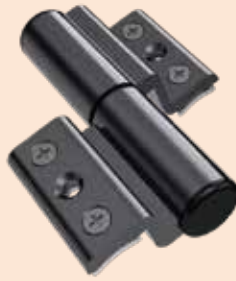
ZH-083 ◆ 分左右，适用于欧标型材的平开门。 ◆ 要求合页通道4-5mm。 ◆ 两个合页最大承重为180kg，具体承重能力与合页安装和型材门设计有关。 ◆ 合页偏心可调。
