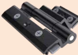
ZH-121-1 ◆ 适用于欧标型材的平开窗。 ◆ 两个合页最大承重为65kg，具体承重能力与合页安装和型材窗设计有关。
